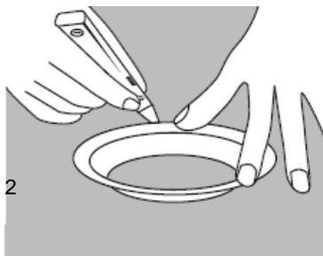
Nach dem genauem Platzieren des Abfluss flansches oberhalb des Syphons wird der innere Radius auf dem Bodenbelag angezeichnet und anschließend mit einem Cuttermesser
